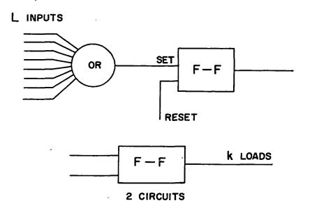
Fig. 18. Logic required per catena
